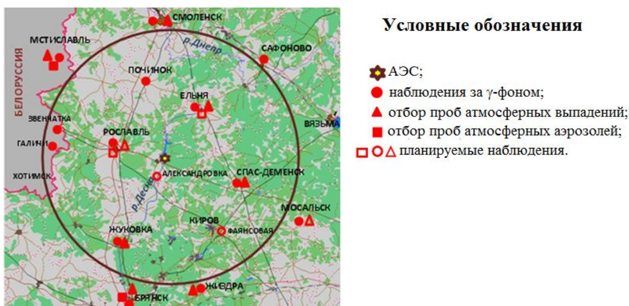
Рис. 7. Расположение пунктов радиационного мониторинга в 100-км зоне вокруг САЭС.
